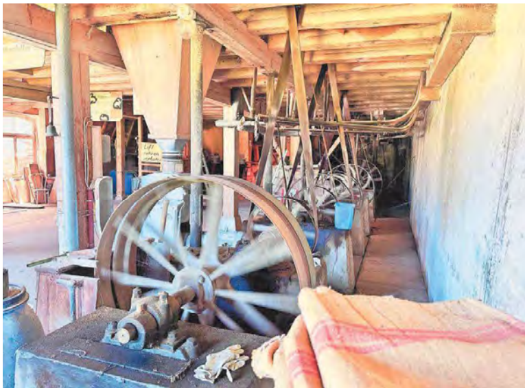
Eine Turbine im Keller und Transmissionsriemen bringen die Energie des Müllibachs in alle Stockwerke.
